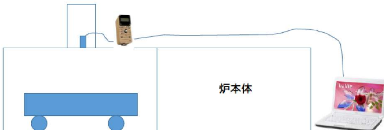
図 5-4 測定装置の設置状況
